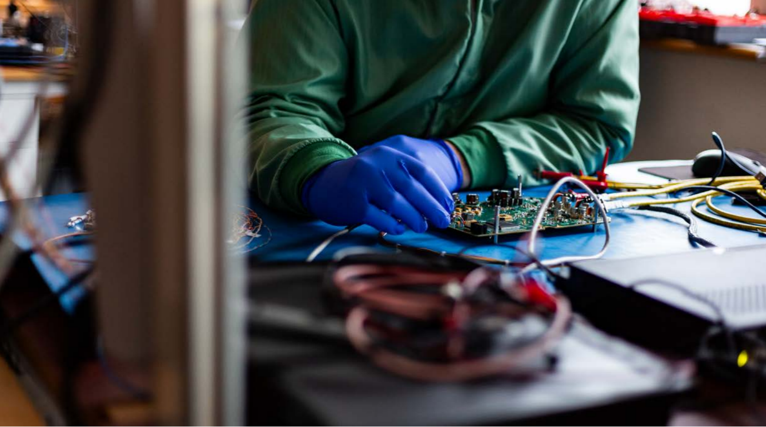
Bild 2.13: Martin Berglund, forskningsingenjör, utför ett funktionstest på ett instrument till rymdsonden Comet Interceptor.
